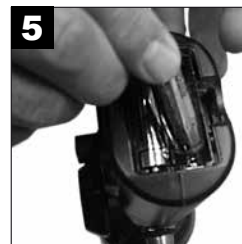
5 Installera batterier vid behov (kontrollera polariteten).
