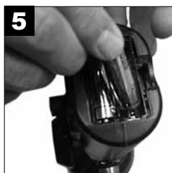
5 Installez des piles si nécessaire (respectez la polarité).
