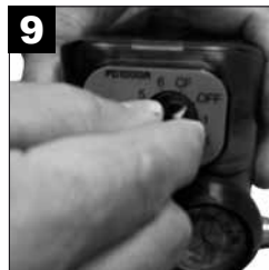
9 När du är klar med att använda iFill-syre-cylindern, flytta selektorn till läget "OFF" (AV).
