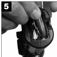
5 Installer batterier hvis det er nødvendig (observer polaritet).
