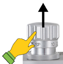
Ventil APL s rychlým odvzdušněním (nadzdvihnutí hlavy ventilu)
