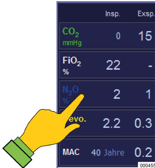
Die Anzeige des MAC-Wertes und die Alterseingabe zur Berechnung geschehen im Fenster Gasmessung.
