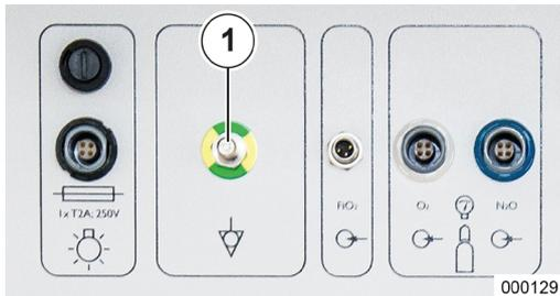
Um den Potentialausgleich herzustellen, verbinden Sie einen dafür vorgesehenen Anschluss am Aufstellungsort über einen geeigneten Leiter (Potentialausgleichskabel HuL Art.-Nr. 0170501) mit dem dafür vorgesehenen Potentialausgleich am Gerät.
