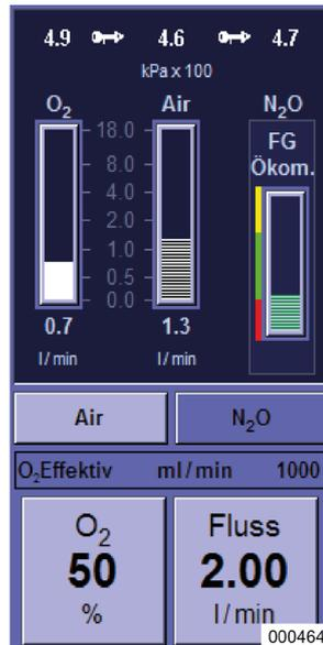
Bei intaktem Frischgasmischer erfolgt innerhalb der Röhre die grafische Darstellung der fließenden Menge O<sub>2</sub>, AIR und N<sub>2</sub>O.
