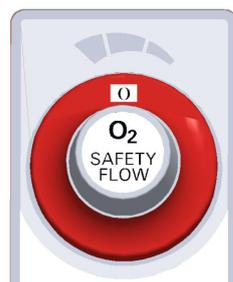
Die O<sub>2</sub>-Notdosierung befindet sich oben im Optionsträger. Sie ist durch einen roten Ring gekennzeichnet. Es handelt sich um ein Rasterflowmeter mit einem Einstellbereich von 0 (AUS) – 15 l/min. Einstellwerte sind: 0, 4, 5, 6, 7, 8, 9, 10, 12, 15 l/min.
