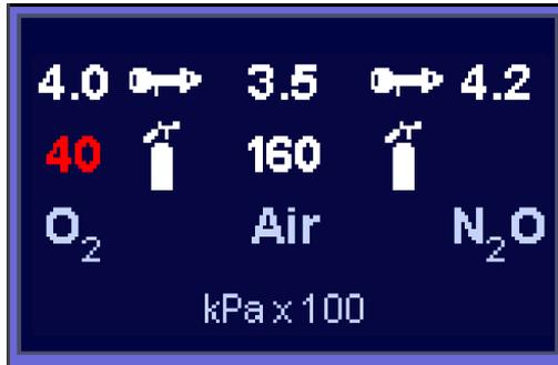
Wird der leon *plus* über 10-l-Gasflaschen mit Frischgas versorgt und wird der Druck der Flaschen überwacht, wird dies durch ein Gasflaschensymbol kenntlich gemacht. Der Wert (40 kPa × 100 (bar)) neben dem Flaschensymbol ist der Druck der 10-l-Flasche. Der Wert neben dem Entnahmesteckersymbol (4,0 kPa × 100 (bar)) zeigt den Druck am Gaseingang des leon *plus* an.
