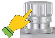
4. Régler la soupape APL sur le module patient sur une valeur correspondant à la limitation de pression (par ex. 20 Pa × 100 (mbar)).
