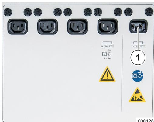
Le raccord pour l'alimentation en tension se trouve en haut à droite sur la face arrière de l'appareil.
