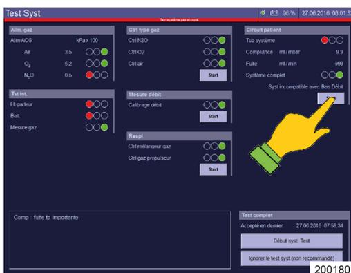
Lorsque le test du système n'est pas réussi, les blocs de test du système non réussis peuvent être renouvelés individuellement. Lorsque ceux-ci sont ensuite réussis, le test du système complet est considéré comme réussi. Lorsqu'un bloc de test du système ne réussit pas, la barre rouge reste visible.
