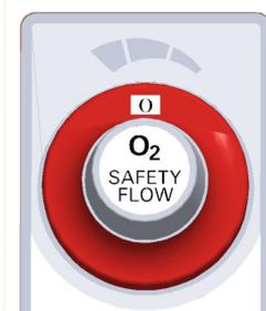
Le dosage d'O<sub>2</sub> se trouve en haut dans le support d'options. Il est caractérisé par une bague rouge. Il s'agit d'un débitmètre gradué avec une plage de mesure de 0 (ARRÊT) à 15 l/min. Les valeurs de réglage sont : 0, 4, 5, 6, 7, 8, 9, 10, 12, 15 l/min.
