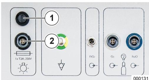
Le câble d'alimentation en tension de la lampe est passé à travers le passage de câble en haut à gauche et branché dans la prise femelle prévue à cet effet (codage de forme et bague noire). Le fusible de la lampe se trouve au-dessus de la prise femelle.
