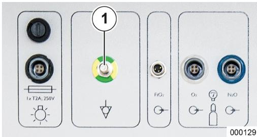
Afin d'établir la compensation de potentiel, relier un raccord prévu à cet effet sur le lieu d'installation à la compensation de potentiel prévue pour cela sur l'appareil par le biais d'un conducteur adapté (câble de compensation de potentiel HuL réf. 0170501).
