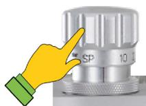
1. Régler la soupape APL sur le module patient sur une valeur correspondant à la limitation de pression (par ex. 10 Pa × 100 (mbar)).
