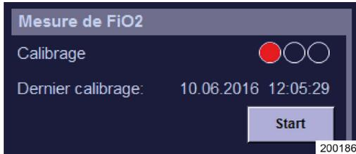
Lorsque le test échoue, le feu est rouge est la description exacte de l'erreur survenue dans le test s'affiche en bas à gauche dans l'écran du test du système.
