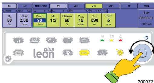
Sans utiliser l'écran tactile, il est tout d'abord nécessaire d'activer la fenêtre correspondante à l'aide d'un bouton sur le clavier à effleurement.
