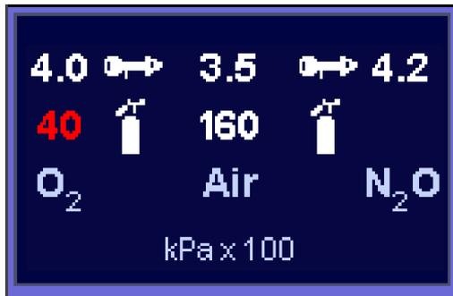
Lorsque le leon *plus* est alimenté en gaz frais via des bouteilles de 10 l et que la pression des bouteilles est surveillée, un symbole de bouteille de gaz l'indique clairement. La valeur (40 kPa × 100 (bar)) à côté du symbole de bouteille correspond à la pression de la bouteille de 10 l. La valeur à côté du symbole de la fiche de prélèvement (4,0 kPa × 100 (bar)) indique la pression sur l'entrée de gaz du leon *plus*.
