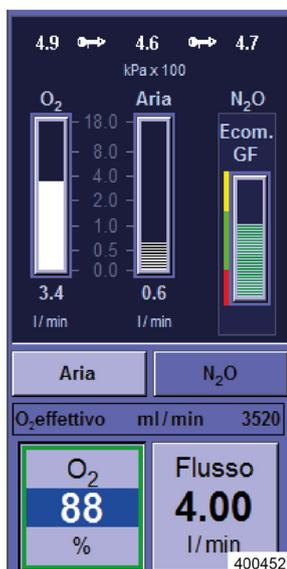
A destra nella finestra del miscelatore di gas fresco è visibile un rotametro suddiviso in tre parti. A seconda dell'intensità del flusso di O<sub>2</sub> e gas fresco il rotametro diventa di colore rosso, verde o giallo.
