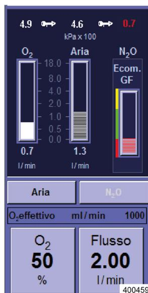
Il pulsante per la selezione del gas mancante (in questo caso l'N<sub>2</sub>O) come gas vettore è rappresentato come inattivo con l'apposito colore. Il gas non deve più essere usato come gas vettore. In caso di guasto dell'ICG, N<sub>2</sub>O e O<sub>2</sub> possono essere messi a disposizione tramite bombole di riserva. Se viene a mancare l'ARIA si usa l'O<sub>2</sub> come gas motore.
