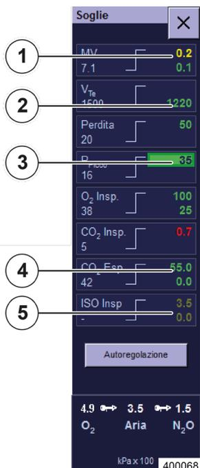
Questa finestra può essere aperta esclusivamente mediante un pulsante da tastiera a membrana. Subito dopo l'apertura viene selezionato l'allarme attivo in quel momento. Se si attiva un allarme e la finestra è già aperta, occorre selezionare manualmente l'allarme.
