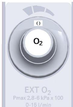
L'intervallo di regolazione del flussometro per l'uscita esterna di O<sub>2</sub> è compreso fra 0 (OFF) - 15 l/min. I valori discreti impostabili sono: 0, 1, 2, 3, 4, 5, 6, 9, 12, 15 l/min.
