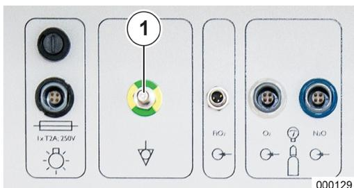
Per realizzare il collegamento equipotenziale, unire l'apposito attacco previsto sul luogo di installazione a quello posto sull'apparecchio mediante un conduttore idoneo (conduttore per collegamento equipotenziale HuL codice art. 0170501).
