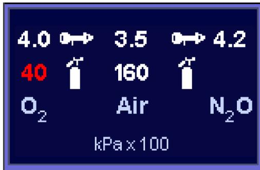
Se l'alimentazione di gas fresco del respiratore per anestesia *leon plus* avviene mediante bombole da 10 l e se la pressione delle bombole è monitorata, tale stato è indicato dal simbolo di una bombola di gas. Il valore (40 kPa × 100 (bar)) accanto al simbolo della bombola rappresenta la pressione della bombola da 10 l. Il valore accanto al simbolo dell'innesto (4,0 kPa × 100 (bar)) rappresenta la pressione all'ingresso gas del respiratore per anestesia *leon plus*.
