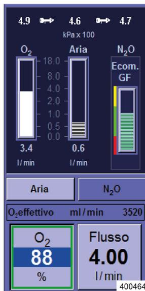
Con il miscelatore del gas fresco intatto all'interno dei rotametri si ha la rappresentazione grafica della quantità di O<sub>2</sub>, ARIA e N<sub>2</sub>O in circolo.
