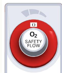
La valvola del flusso di emergenza di O<sub>2</sub> si trova nella parte superiore del portadispositivi opzionali ed è contrassegnata da un anello rosso. Si tratta di un flussometro con regolazione a scatti e un intervallo di regolazione da 0 (OFF) a 15 l/min. I valori discreti impostabili sono: 0, 4, 5, 6, 7, 8, 9, 10, 12, 15 l/min.
