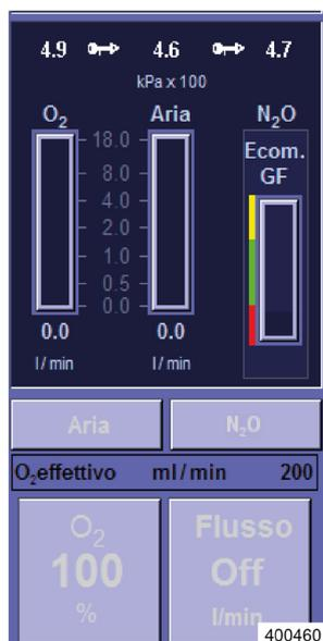
In caso di guasto al miscelatore, i pulsanti di selezione dell'ARIA o dell'N<sub>2</sub>O come gas vettore, il pulsante di regolazione del flusso e quello per l'impostazione della percentuale di O<sub>2</sub> nel gas fresco sono rappresentati come inattivi con l'apposito colore. L'ARIA e l'N<sub>2</sub>O non devono più essere utilizzati come gas vettore.
