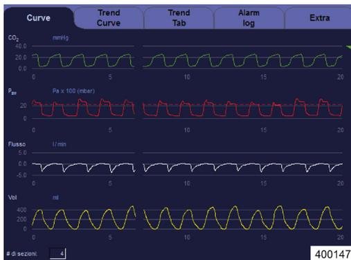
Per il monitoraggio vengono visualizzati sotto forma di curve i seguenti valori di misura (è possibile raffigurare in forma di curva da un minimo di uno a un massimo di quattro valori di misura):
