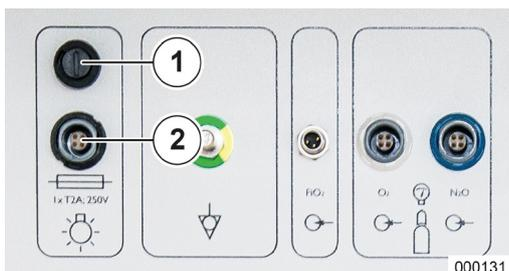
Il cavo di alimentazione della luce viene condotto attraverso l'apposito foro di passaggio in alto a sinistra e inserito nella presa (con codifica di forma e anello di colore nero). Al di sopra della presa si trova il fusibile della luce.
