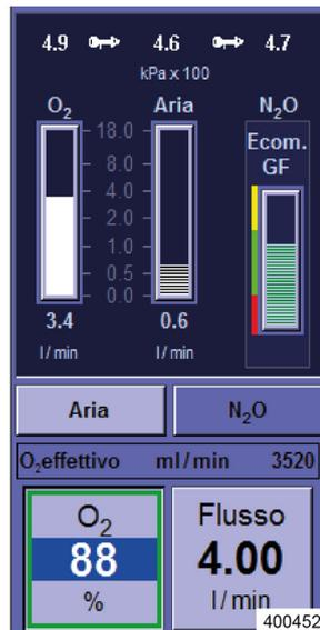
Le quantità di gas fresco sono rappresentate tramite grafici a barre. Possono essere configurati i seguenti valori iniziali del miscelatore di gas fresco:
