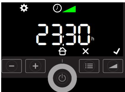
Кнопки аппарата могут выполнять различную функцию. Если на дисплее над кнопкой отображается символ (например, над кнопкой плавного пуска), то кнопка выполняет функцию соответствующего символа. Если над кнопкой символ отсутствует (например, над кнопкой ), то кнопка сохраняет свою первоначальную функцию.
