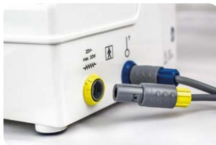
Lors de l'utilisation d'un système de tuyaux respiratoires chauffants, le connecteur du câble de distribution des fils chauffants est relié au branchement jaune (symbole
