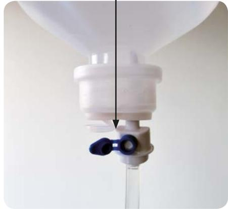
e inserire il perforatore della cannula di allacciamento nella membrana in gomma.
