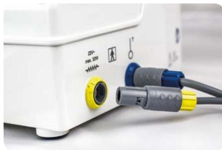
Qualora si utilizzi un circuito respiratorio riscaldato, il connettore del cavo distributore riscaldante viene collegata all'allacciamento giallo (simbolo
