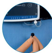
3. Vissez le raccord noir de la ceinture ventrale d'environ un demi-tour sur l'embout noir sous l'appareil.
