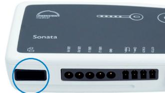
Anschluss für Verbindungskabel
