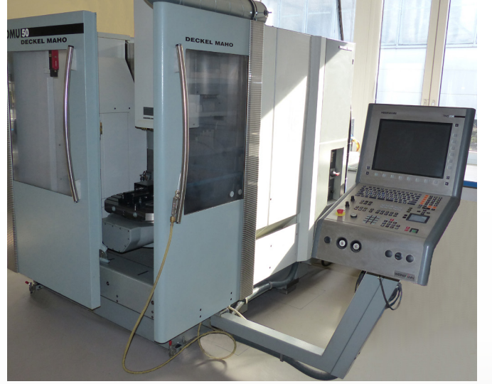
Alüminyum kalıpları hazırlayan freze makinesi
