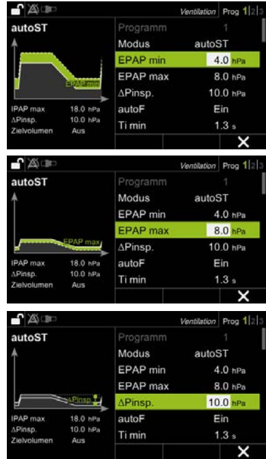
Abb. 12 Eine individuelle Anpassung zwischen EPAP min–max sowie ein festgelegtes Druckdelta Pinsp. ermöglicht eine automatische Druckanpassung für den Patienten und hilft, Obstruktionen zu beseitigen.
