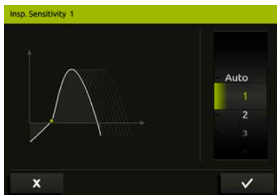
Abb. 8 Darstellung Beatmungsgerät LUISA: Triggereinstellungen in Manuell und Auto. Für die Beatmungseffizienz ist eine an den Patienten angepasste Triggersensitivität von Vorteil. Dabei erfolgt die manuelle inspiratorische Einstellung in 8 Stufen.
