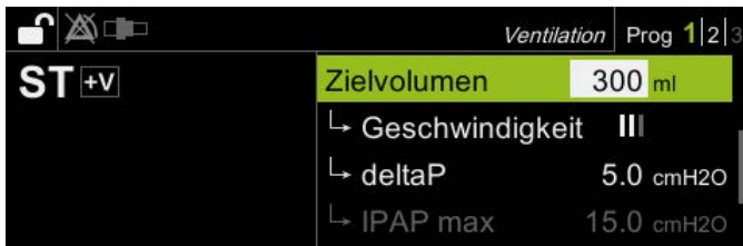
Abb. 7 Zielvolumen bei prisma VENT 30/40/50/50-C – die Geschwindigkeit kann den Bedürfnissen des Patienten angepasst werden. Sie ist in drei Stufen einstellbar.
