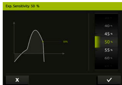
Abb. 9 Darstellung Beatmungsgerät LUISA: Triggereinstellungen. Die expiratorische Einstellung von 95–5 % erfolgt in Schritten von 5 %. Um mögliche Fehltriggerungen in der Expirationsphase zu vermeiden, kann zusätzlich eine Trigger-sperrezeit hinterlegt werden.
