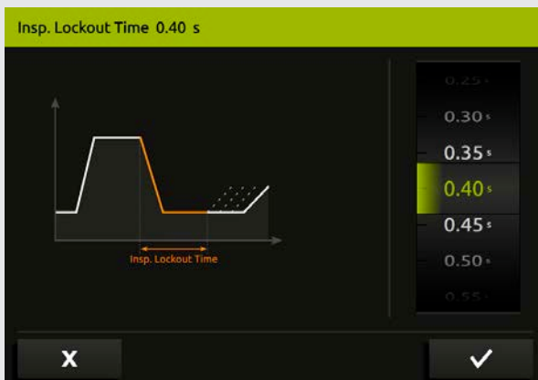
Abb. 30 LUISA Bedienmenü: Die Triggersperrzeit lässt sich von 0,2 s bis [(60/F) - T_i] maximal 5 sec. einstellen.
