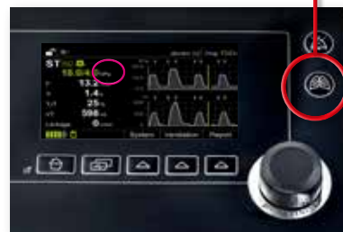
Figura 39 prisma VENT50/50-C con tasto LIAM per attivare/disattivare la funzione LIAM
