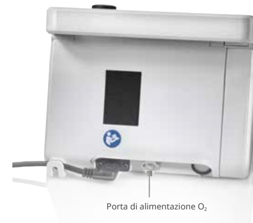
Figura 37 Vista posteriore di prisma VENT30/40/50/50-C con porta ossigeno. Il punto in cui l'ossigeno viene immesso nel sistema fa sì che l'ossigeno venga incluso nel percorso di misurazione della portata.
