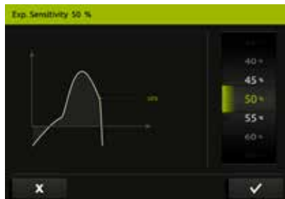
Figura 9 Exemplo: LUISA: Ajuste do disparo expiratório: O ajuste expiratório de 5% a 95% é feito em incrementos de 5%. O bloqueio do disparo pode ser definido, para evitar possíveis falsos disparos na fase expiratória.
