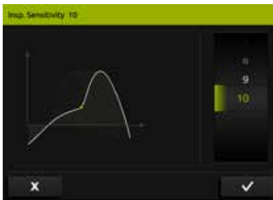
Figura 18 aPCV/ aVCV, o ajuste de frequência invariável é moderado pela inspiração assistida. O fator crítico é o ajuste do limite de disparo. Se o ajuste for muito alto, o paciente não conseguirá disparar a inspiração. Em seguida, a ventilação controlada é administrada ao paciente.
