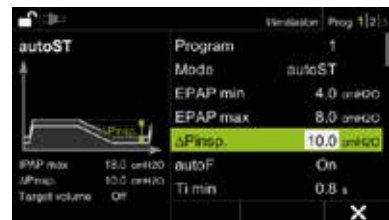
Figura 12 Um ajuste específico do paciente entre a EPAP mínima e um delta de pressão definido (P insp ) permitem fazer o ajuste automático da pressão para o paciente, ajudando a eliminar as obstruções.
