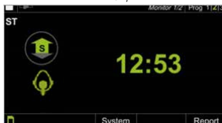
Figura 49 O símbolo de máscara verde indica um bom ajuste da máscara respiratória.
