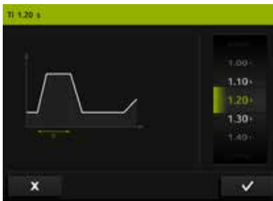
Figura 17 Apresentado no ventilador LUISA. Nos modos aPCV/ aVCV, o tempo inspiratório é definido de forma fixa.
