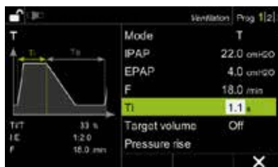
Figura 11 Modo T (ventilação controlada). O exemplo mostra uma IPAP de 22,0 cmH 2 O e uma EPAP de 4,0 cmH 2 O. O paciente é ventilado com uma taxa respiratória de 18/min e uma relação I:E de 1:2.
