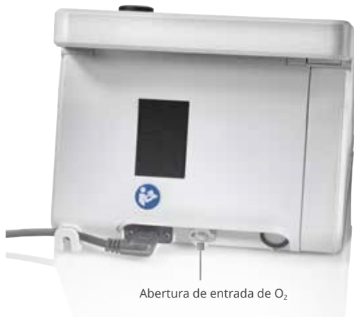
Figura 37 Vista traseira do prisma VENT30/40/50/50-C com entrada para oxigênio. O ponto em que o oxigênio é fornecido ao sistema é selecionado de forma a ser capturado na trajetória da medição do fluxo.
