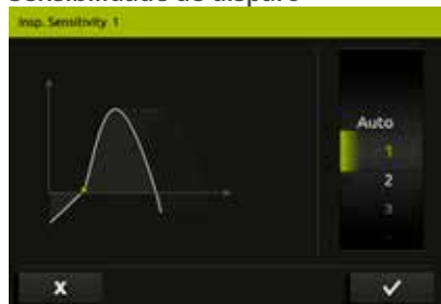
Figura 8 Exemplo: LUISA: Ajuste do disparo expiratório nos modos Manual e Auto. A eficiência do ventilador é positivamente afetada por uma sensibilidade de disparo especificamente definida para um paciente. O ajuste inspiratório manual é feito em oito (8) níveis.
