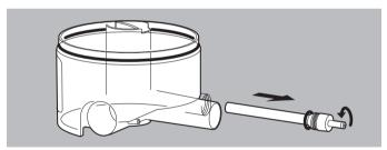
Desenroscar la barra calentadora de la parte inferior de la carcasa.
