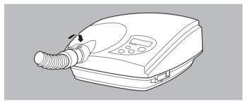
2. Enchufe el tubo flexible de respiración en el adaptador. Tenga en cuenta: la tecla de bloqueo debe enclavar audiblemente.
