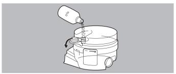
3. Llenar el humidificador del aire de respiración con agua destilada fría hasta la marca "máx.".
