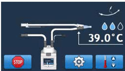
изображение экрана для увлажнителя при конфигурации с обогреваемым шлангом вдоха и выдоха
