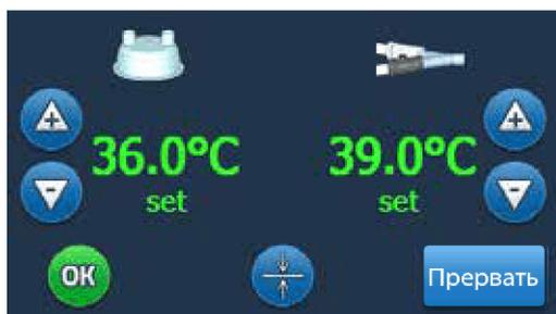
"Экран для регулирования температуры дает Вам возможность изменить регулируемую температуру на выходе увлажнительной камеры (слева) и на зонде на стороне пациента (справа).
