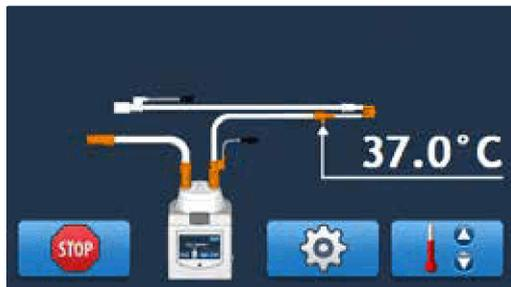
изображение экрана для увлажнителя при конфигурации с обогреваемым шлангом вдоха и выдоха
