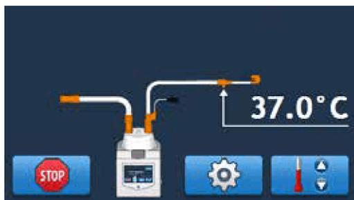
изображение экрана для увлажнителя при конфигурации только с обогреваемым шлангом вдоха
