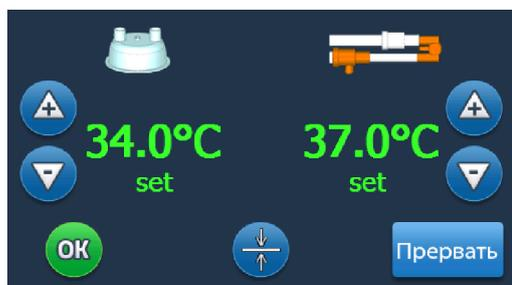
"Экран для регулирования температуры дает Вам возможность изменить регулируемую температуру на выходе увлажнительной камеры (слева) и на зонде на стороне пациента (справа).
