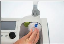
Entfernen Sie das Schlauchsystem mit der Wasserkammer und setzen Sie den Filter sowie die grüne Kappe wie auf der Abbildung sichtbar ein.
