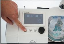
Drücken Sie die Start-/Stopp-Taste für 3 Sekunden, um die Therapie zu beenden und den Trocknungsmodus zu starten bzw. zu beenden. Entfernen Sie das Schlauchsystem und dekonnectieren Sie das Gerät von der Stromquelle.
