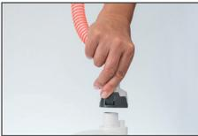
Konnektieren Sie den roten Schlauch mit dem Atemgasauslass und das Ozondesinfektionsgerät mit dem offenen Anschluss.
