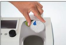
Zum Abschluss der Desinfektion entfernen Sie den Filter und trennen Sie den Therapieschlauch sowie das Ozondesinfektionsgerät vom High-Flow-Gerät. Nutzen Sie das Gerät für mindestens eine Stunde nach der Desinfektion nicht.
