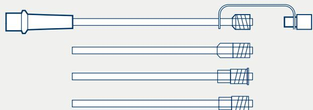
Ligne de mesure de pression avec robinet à 3 voies et embouts Luer-Lock
